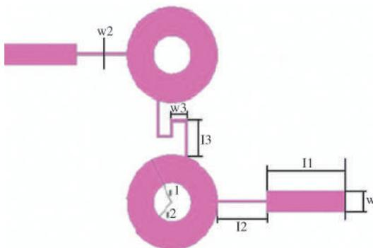
Figura 5. Esquema superior.
