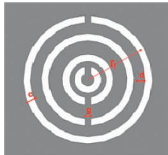
Figura 2. Geometría de la célula unitaria del CSRR.
