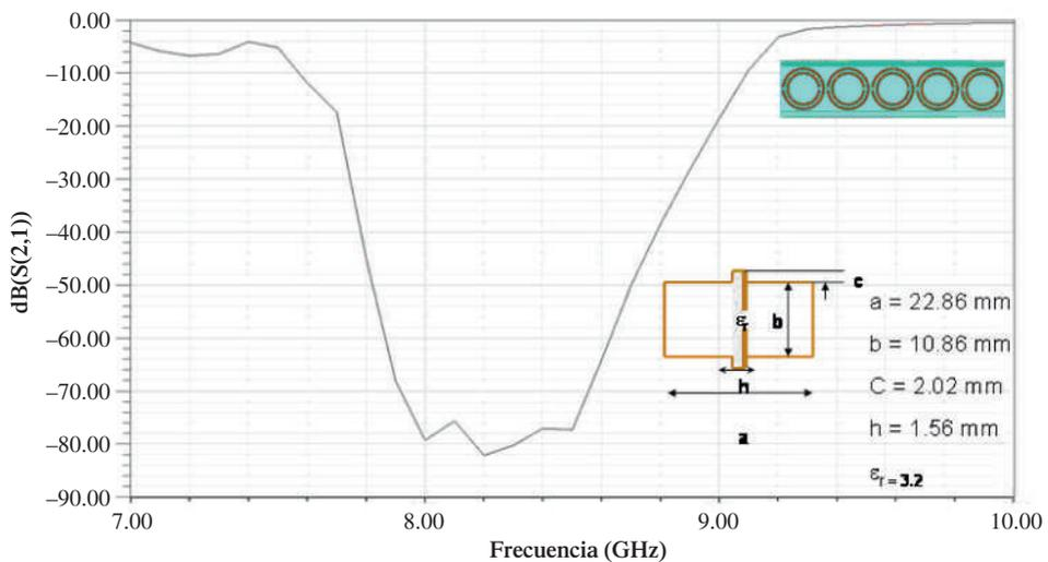
Figura 10a. Pérdidas de inserción del BSF en configuración finline y su esquema.
