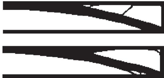
Figura 10. Topologías óptimas  $f=0,5$  a) Sin restricción de desplazamiento (arriba). b) Con restricción de desplazamiento (abajo).
