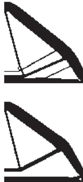
Figura 6. Topologías óptimas  $f=0,3$ , a) Sin restricción de desplazamiento (arriba). b) Con restricción de desplazamiento (abajo).
