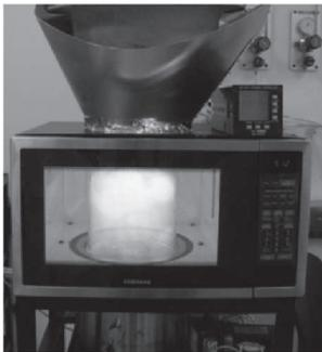
Figura 10. Imagen del sistema de deposición construido.
