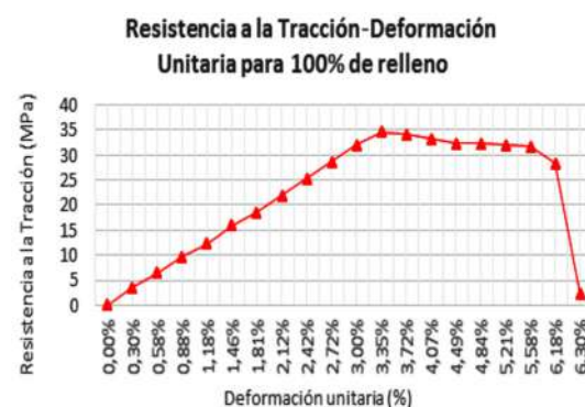
Gráfico 1. Curva Resistencia a la Tracción-Deformación Unitaria para 100% de relleno.
