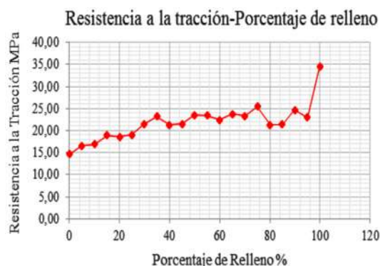
Gráfico 2. Curva Resistencia a la tracción-Porcentaje de relleno.
