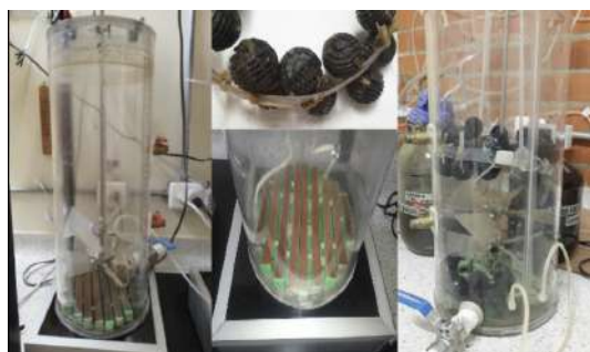
Figura 1. Detalles constructivos del SBR a escala laboratorio.
