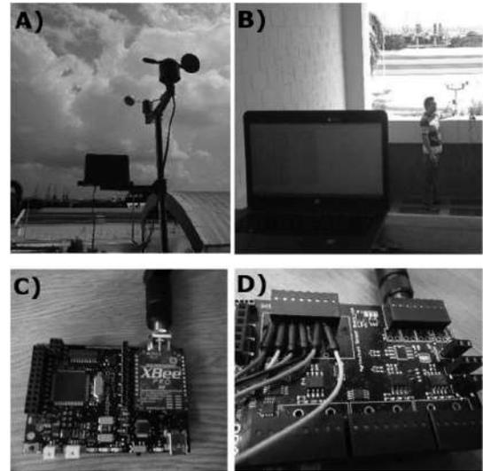
Figura 8. A) Estación meteorológica WS-3000; B) Comunicación entre la placa de agricultura de Libelium, el servidor y la estación meteorológica WS-3000; C) Módulo Zigbee; D) Módulo de comunicaciones Zigbee integrada con la placa de agricultura y la estación meteorológica WS-3000.
