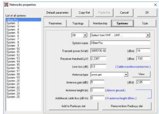
Figura 12. Configuración del módulo de radio en Radio Mobile.
