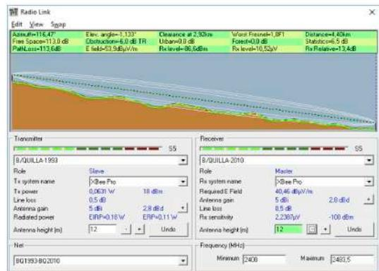
Figura 13. Simulación en el entorno Radio Mobile para el enlace 1.
