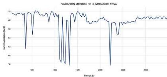
Figura 18. Toma de datos para el sensor de humedad relativa.
