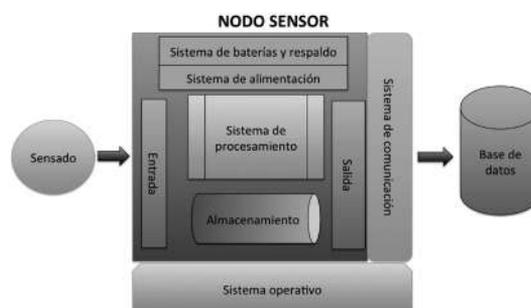
Figura 2. Diagrama de bloques del nodo sensor.
