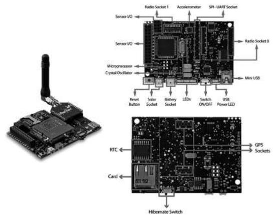
Figura 3. Vista superior y posterior con módulos de comunicación de la placa Libelium Wasmote [46].
