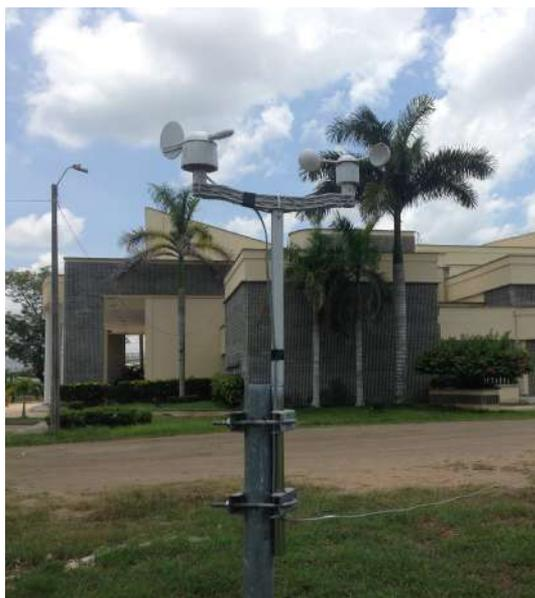
Figura 5. Estación meteorológica WS-3000.
