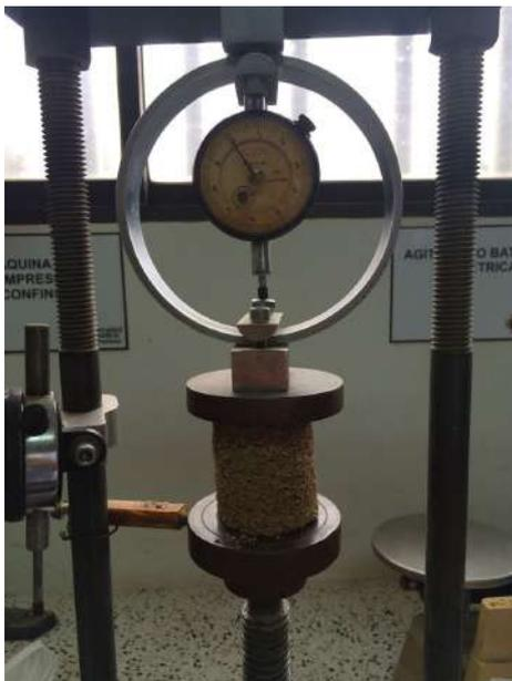
Figura 3. Prueba de Resistencia a la compresión.
