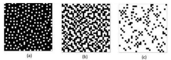
Figura 9. Patrones binarios con diferentes valores de transmitancia (a) t_r = 0,2 (b) t_r = 0,5 (c) t_r = 0,9 .
