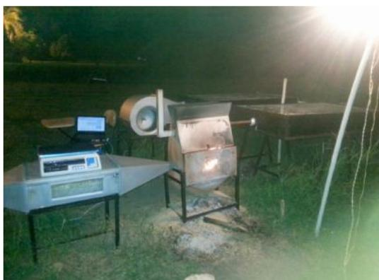
Figura 5. Sistema híbrido de calentamiento de aire en modo combustión de biomasa.
