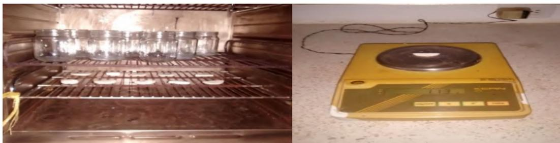
Figura 1. Equipo de secado y balanza analítica para determinar humedad de la yuca.
