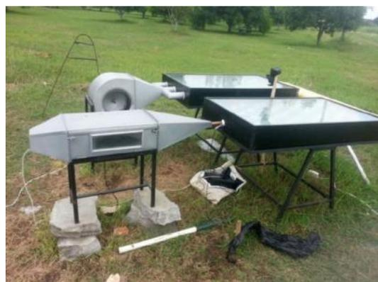
Figura 3. Sistema híbrido de calentamiento de aire en modo solar.
