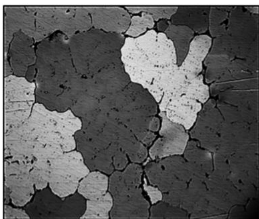
Figura 4. Izquierda: Material homogeneizado por 20h a 480 °C.Derecha: Mismo material tras laminarse en caliente un 11,5% a 440 °C. (200x).
