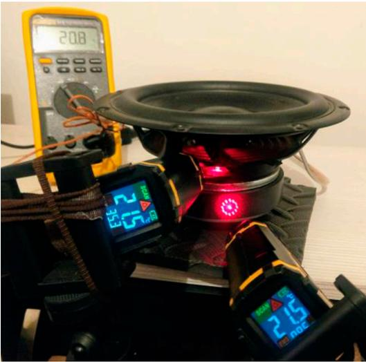
Figura 5. Fotografía medición de la evolución térmica de la bobina e imán del altavoz.
