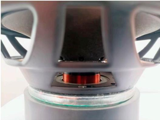
Figura 2. Altavoz Peerless SLS-P830667 de bobina móvil de tipo *overhung*.
