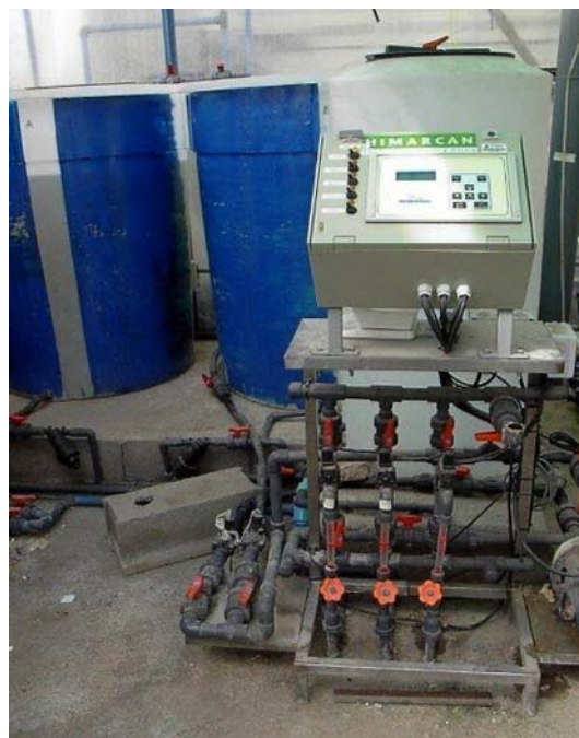
Fotografía 4. Sistema de fertirriego con los tanques para la disolución nutritiva madre y ácido nítrico.
