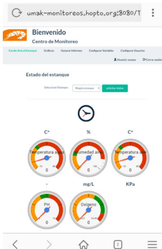
Figura 8. Estado actual del estanque vista Smartphone. Fuente propia.
