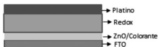
Figura 1. Estructura de las DSSC utilizando ZnO/ Colorante.
