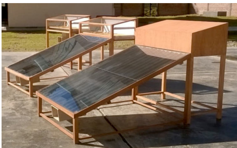
Figura 2. Prototipos de secadores solares construidos.
