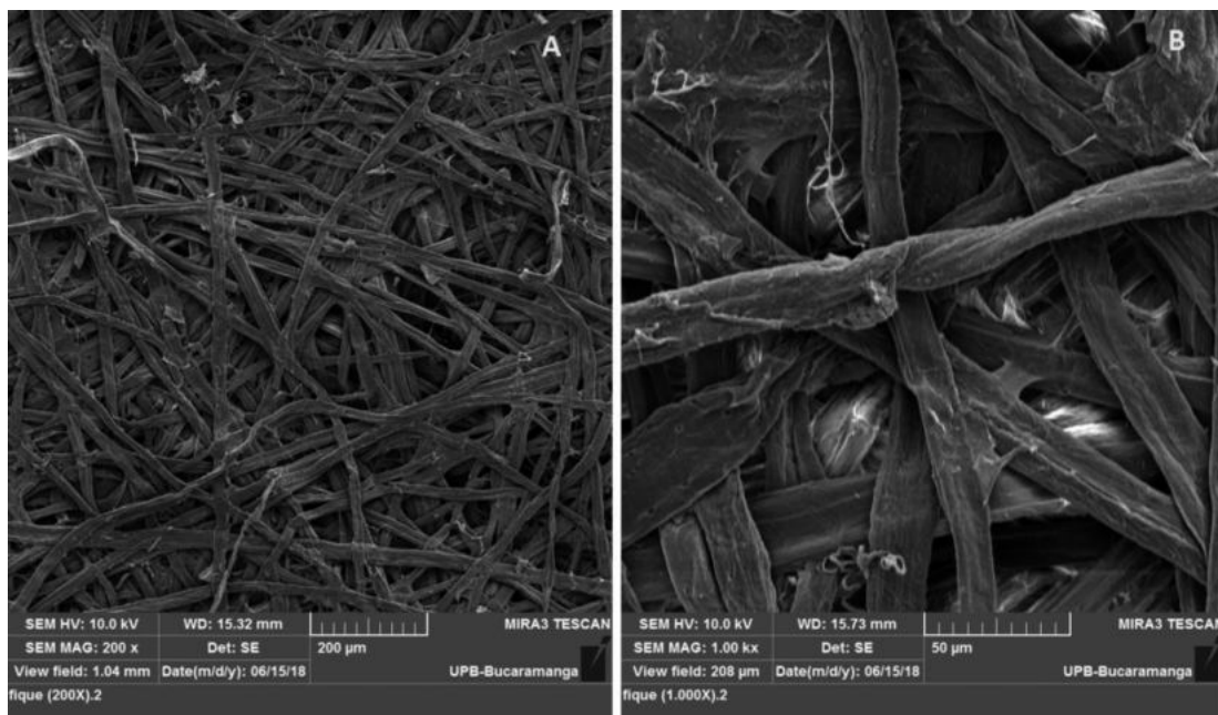
Figura 1. Micrografías SEM del fique organización aleatoria A) escala 200X B) escala 1000X.
