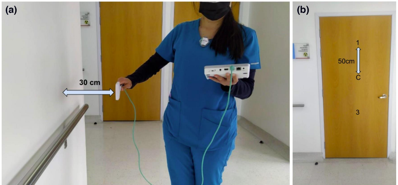
Figura 4. (a) Distancia entre la barrera y el detector. (b) Distribución de los puntos de medida en la barrera.
