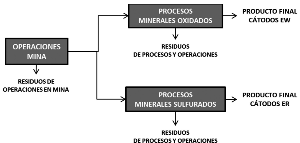
Figura 1. Esquema diferenciado de procesos según origen mineralógico.
