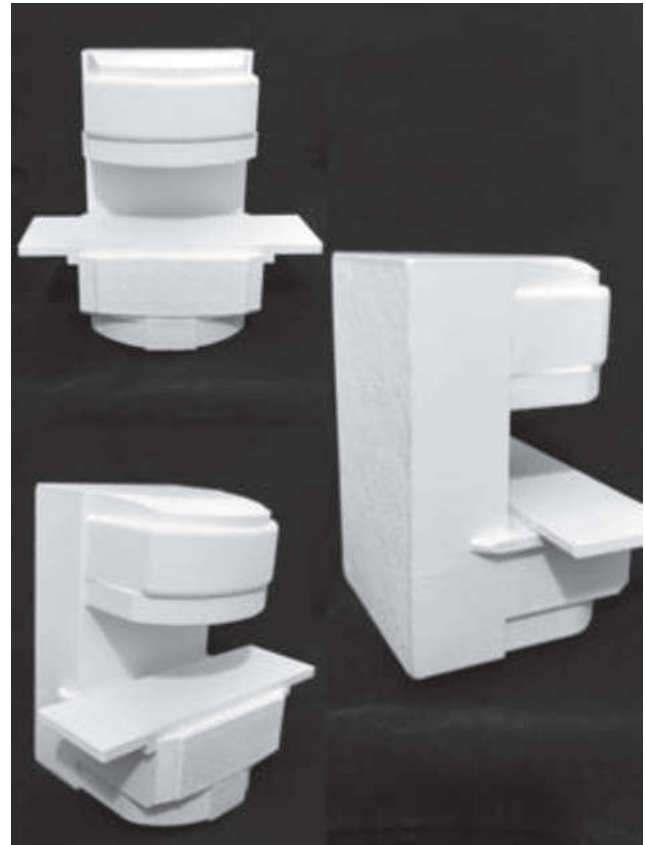
Figura 10. Modelo del equipo de resonancia magnética de campo abierto impreso en 3D.
