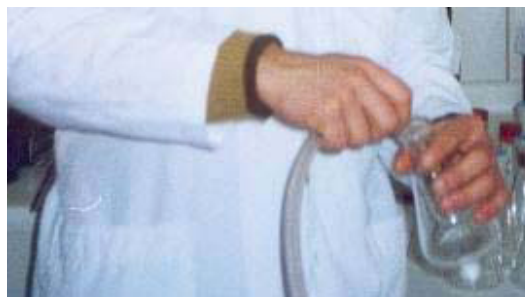
Figura 1. Inyección de gas nitrógeno en matraces de 250 mL preparados para el análisis de índice de peróxidos. Fuente: Propia, 2005.
